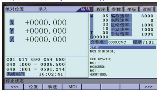
绝对位置 Absolute position 参数 Parameter 编程速率 Programming rate 进给倍率 Feeding ratio 手动倍率 Manual ratio 系统时间 System time 位置 Position 录入 Edit 坐标 Coordinates 实际速率 Actual rate 手动速率 Manual rate 文件名 File name: /程序 Program: 停止状态 Stopped 轨迹 Track 运转 Monitor 程序 Program 诊断 Diagnosis
