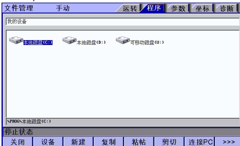
文件管理 File management 手动 Manual 运转 Monitor 程序 Program 参数 Parameter 坐标 Coordinates 诊断 Diagnosis 我的设备 My devices 本地磁盘(C:)al disk (C:) 本地磁盘(D:) Local disk (D:) 可移动磁盘 Mobile disk (U:) \PROG\本地磁盘(C:) \PROG\Local disk (C:) 停止状态 Stopped 关闭 Close 设备 Equipment 新建 New 复制 Copy 粘帖 Paste 剪切 Cut 连接 PC Connect to PC File Operation Interface
